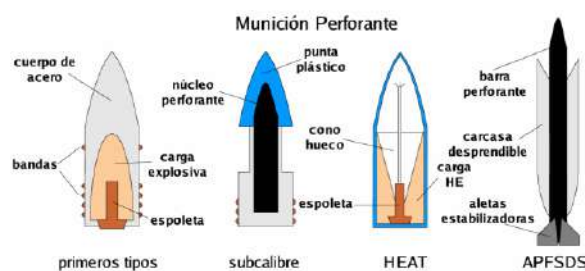
Figura 7 Distintos tipos de proyectiles y las partes que los componen
