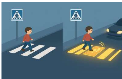
Ilustraci3n 1 Comparativa entre paso peatonal convencional y sistema SafeStep.
